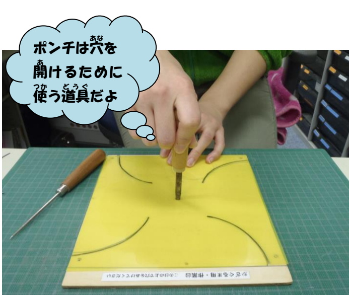
③ ポンチを使い、作業台の上で中心に穴をあけます。
